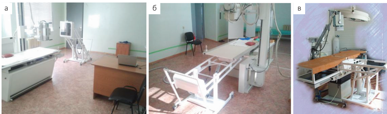
Рис. 3. Приклади доукомплектування працюючого рентгенівського обладнання цифровим приймачем: а,б – рентгенодіагностичного комплексу на 2 робочі місця; в – палатного рентгенапарата, що використовується в операційній травматологічного відділення
