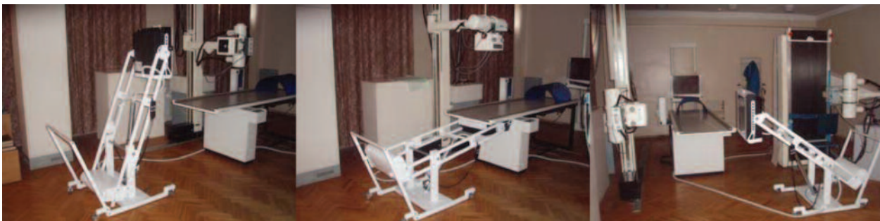
Рис. 4. Рентгенодіагностический комплекс РУМ-20М, дооборудований тележкой S-30Ц з цифровим приймачем «Йона-Р4000»
