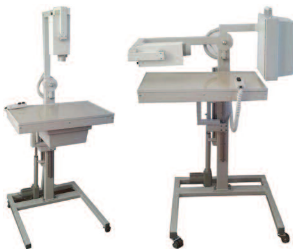
Рис. 3. Цифрова мікрофокусна рентгенографічна система
