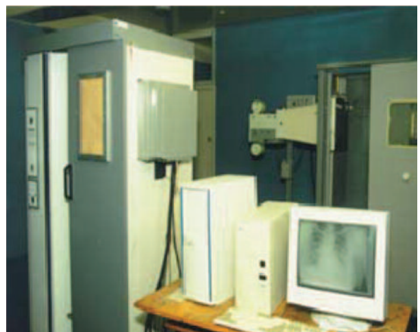
Рис. 1. Первый флюорограф, дооборудованный цифровым приемником «Альфа»
