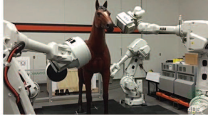
Рис. 2. Конусно-лучевой рентгеновский томограф, состоящий из четырех «рук» робота
