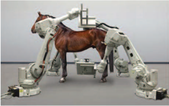
Рис. 2. Конусно-лучевой рентгеновский томограф, состоящий из четырех «рук» робота
